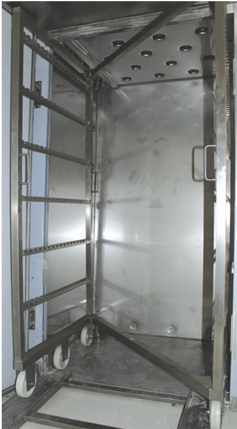
Zdj. 4. KOMORA WĘDZARNICZO-PARZELNICZA (wędzenie, parzenie, studzenie wędlin, wędzonek)
