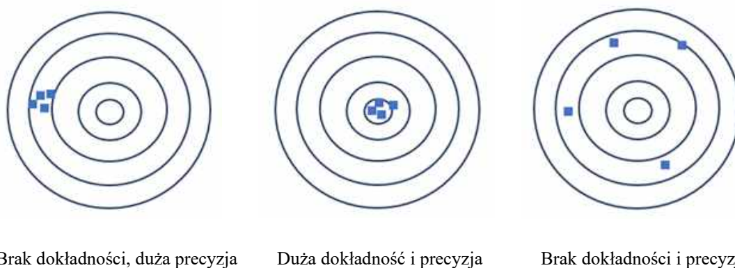
Rysunek 2.25. Rozróżnienie pomiędzy dokładnością a precyzją w aspekcie analizy systemu pomiarowego
