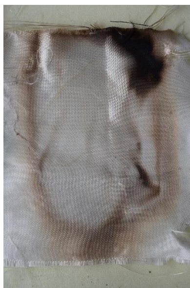
Rysunek 56. Próbką powłoka tzw. kocówka gramatura 560 g/m 2 profil boczny i widok od góry
