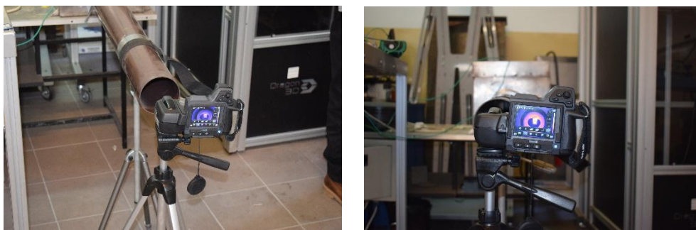
Rysunek 29. Pomiary parametru emisyjności \epsilon_R dla wybranych tkanin. Opracowanie własne
