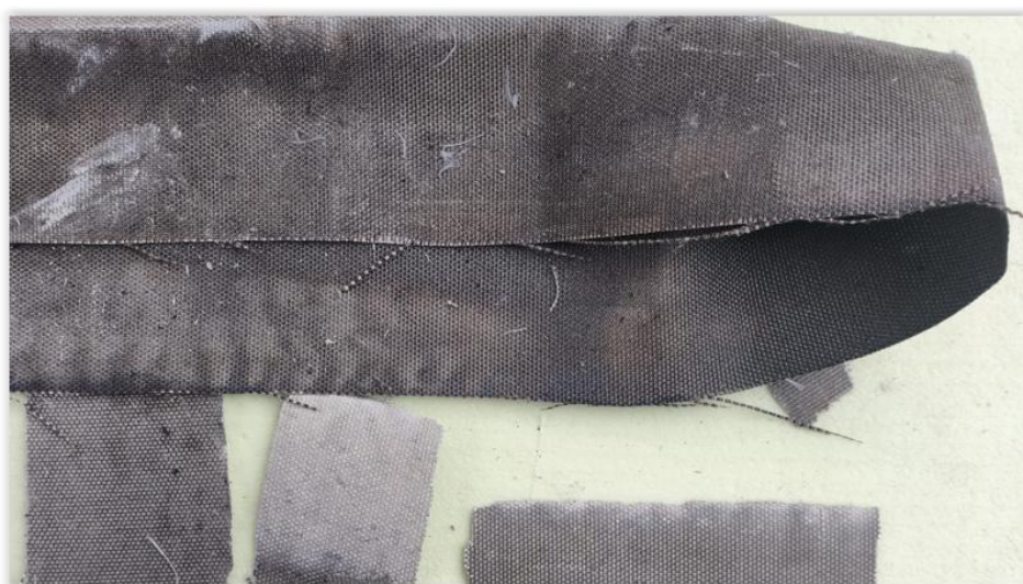
Rysunek 84. Pozostałości osłony z modyfikacją wermikulitem po zdemontowaniu
