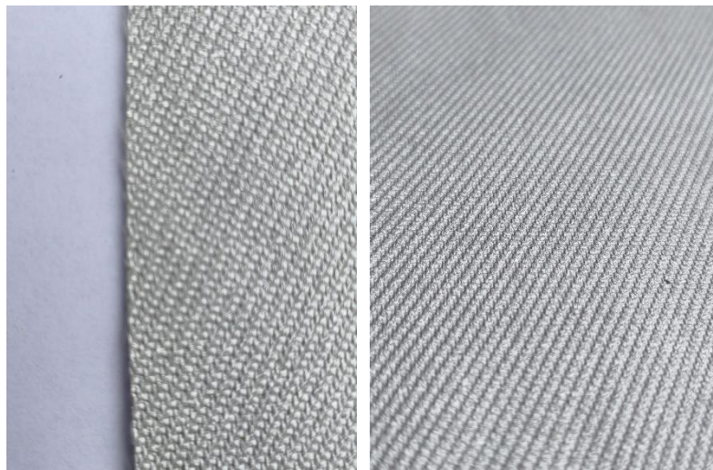
Rysunek 27. Tkanina szklana z powłoką aluminium wariant B– opracowanie własne
