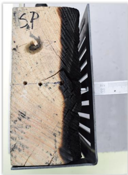
Rysunek 50. Próbką świadek - widok na strony ekspozycji i profil boczny
