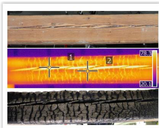
Rysunek 8. Zmiany w rozkładzie temperatur – drewno lite 114
