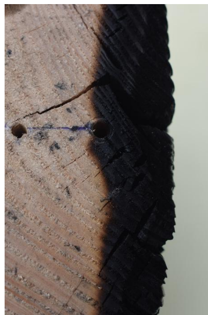
Rysunek 51. Próbką świadek widok na strony ekspozycji i profil boczny
