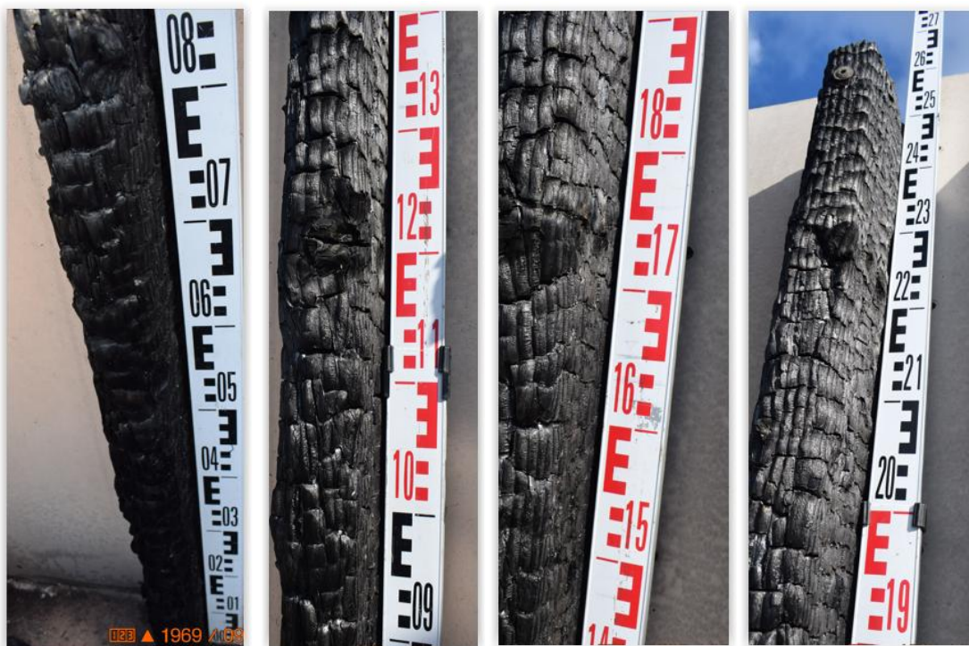
Rysunek 78. Uszkodzenia próbki typu świadek bez zabezpieczeń
