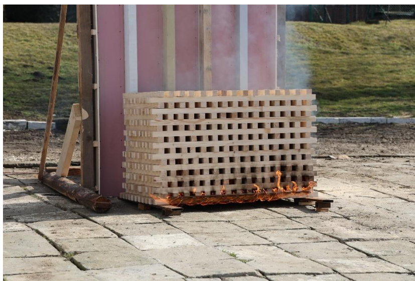
Rysunek 67. Inicjacja pożaru testowego (zapalenia nasączonych pasków w dolnej warstwie).
