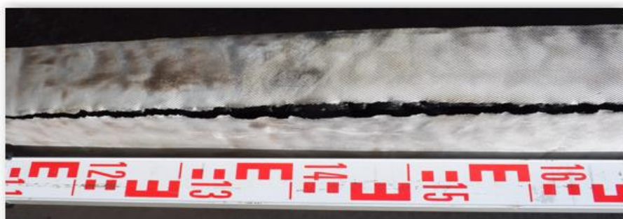
Rysunek 87. Pozostałości powłoki z włókna szklanego gramatura 560 \text{ g/m}^2
