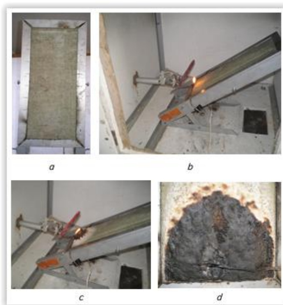
Rysunek 15. Stanowisko badawcze i próbka po badaniach opisana w materiałach Y. Tsapko 132
