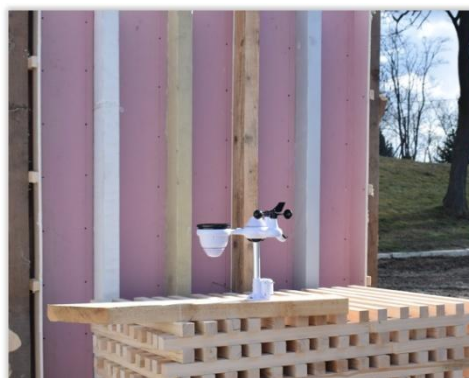
Rysunek 62. Pomiar warunków środowiskowych na stanowisku badawczym
