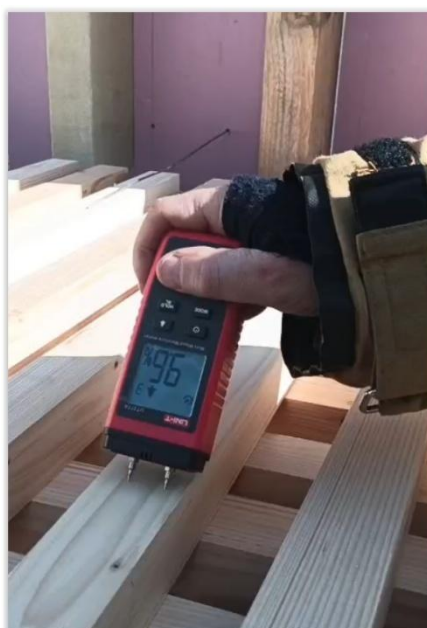
Rysunek 65. Pomiar wilgotności przed rozpoczęciem testów poligonowych
