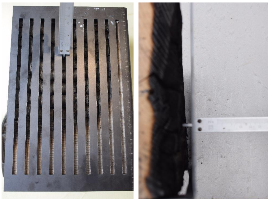
Rysunek 49. Pomiar głębokości zwęglania z wykorzystaniem szablonu
