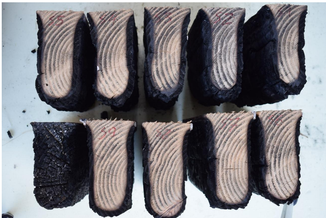
Rysunek 91. Uszkodzenie elementu drewnianego „świadek”
