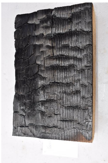
Rysunek 51. Próbką świadek widok na strony ekspozycji i profil boczny
