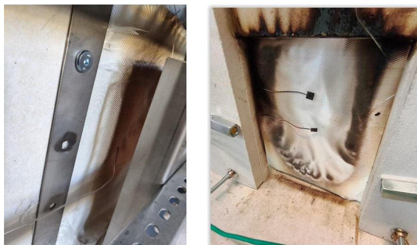
Rysunek 42. Mocowanie tkaniny na stanowisku badawczym: zdjęcie po lewej od strony promiennika, zdjęcie po prawej po zdementowaniu próbki
