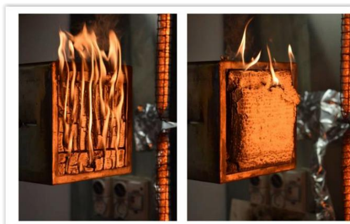
Rysunek 11. Tablica porównanie uszkodzeń: element lewy niezabezpieczony, prawy zabezpieczony farbą pęczniącą 122
