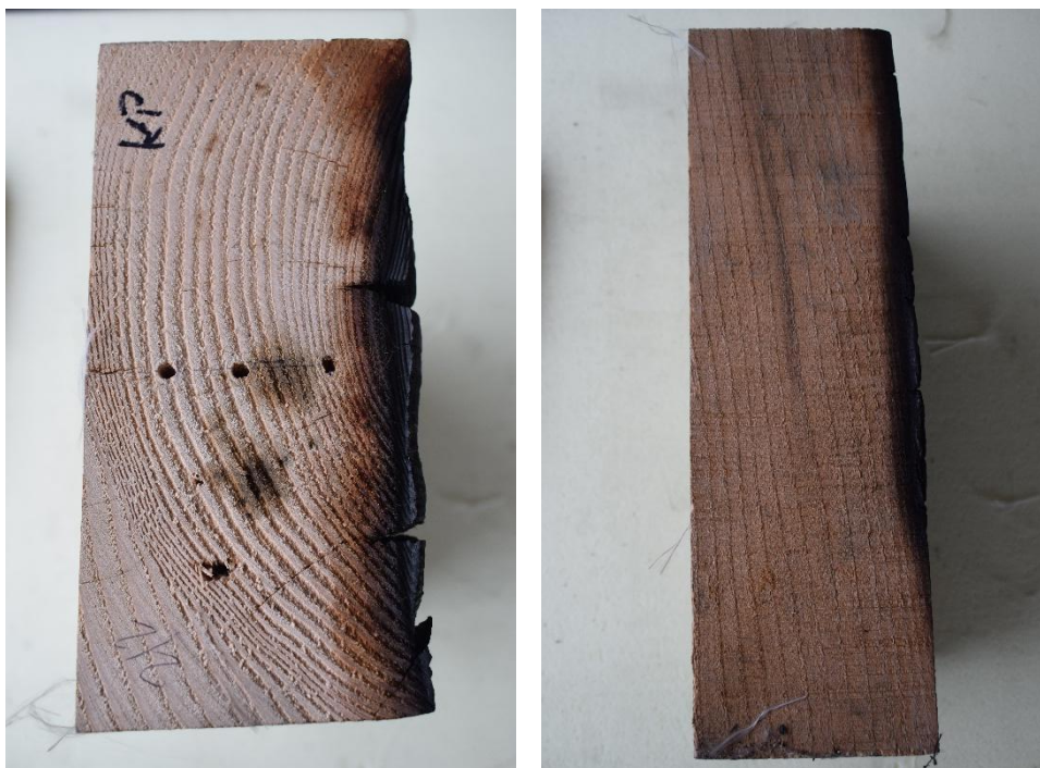
Rysunek 56. Próbką powłoka tzw. kocówka gramatura 560 g/m 2 profil boczny i widok od góry
