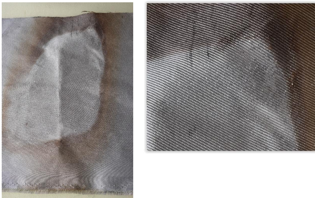
Rysunek 59. Powłoka z modyfikacją płatkami aluminium jednostronnie na stanowisku z promiennikami oraz widoczne wykruszenie lokalne powłoki po badaniu
