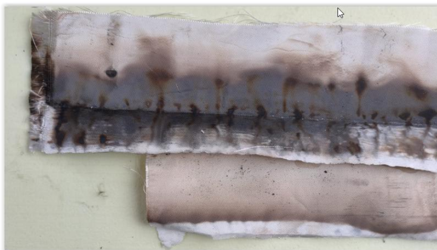
Rysunek 89. Powłoka zabezpieczająca po zdemontowaniu z elementu drewnianego
