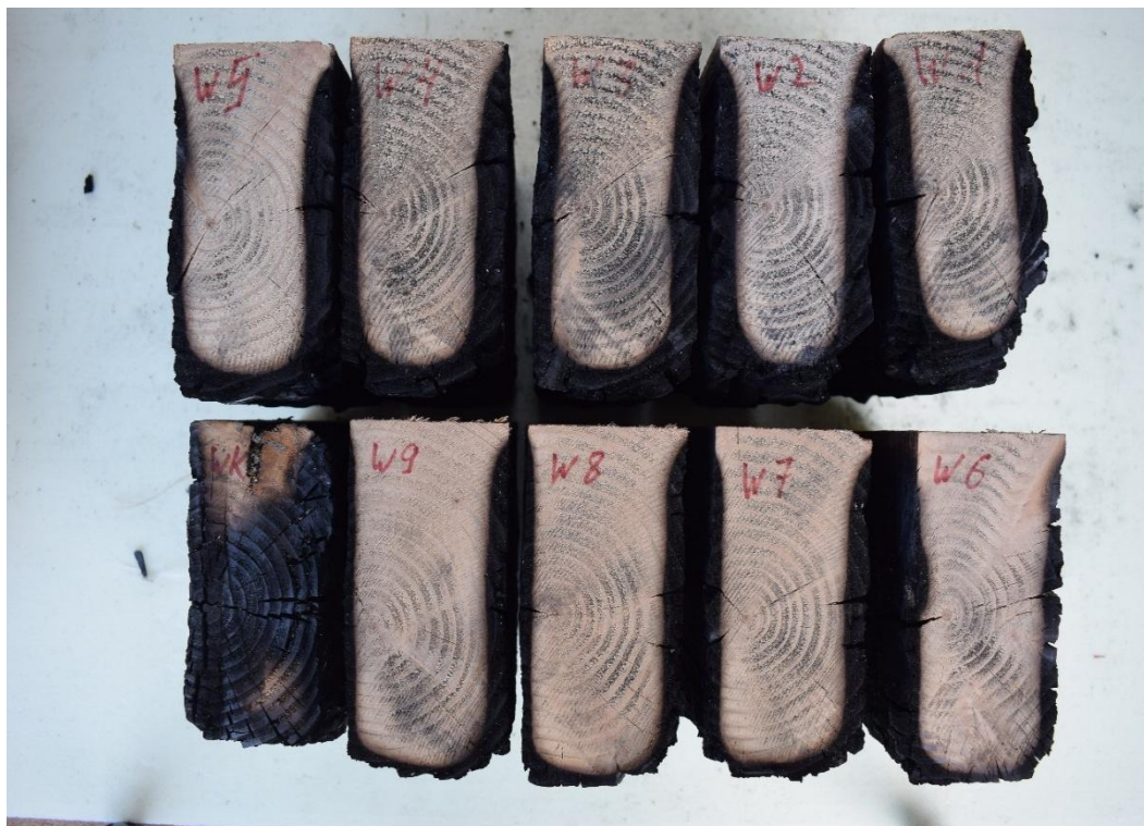
Rysunek 93. Uszkodzenie elementu drewnianego zabezpieczonego włóknem szklanym z modyfikacją wermikulitem
