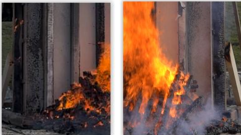
Rysunek 72. Zdjęcie po lewej - widoczne uszkodzenie powłoki element D i C; zdjęcie po prawej - uszkodzenie powłoki element A
