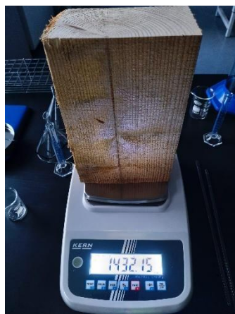
Rysunek 46. Pomiar masy próbki
