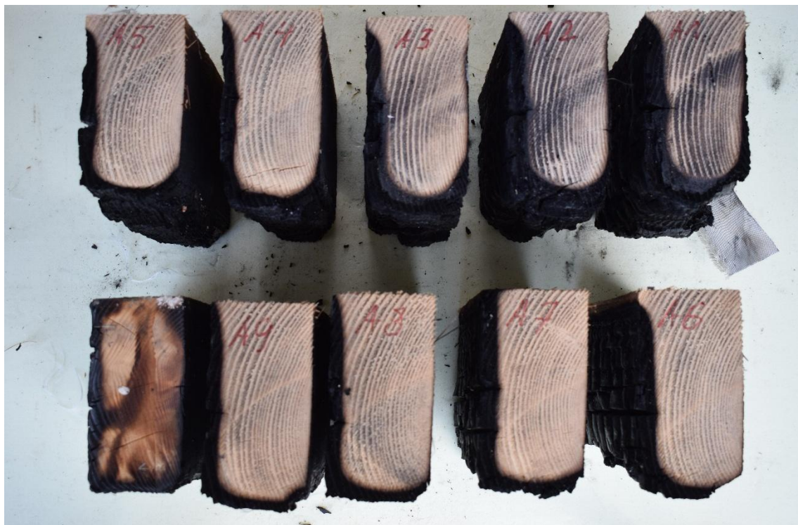
Rysunek 92. Uszkodzenie elementu drewnianego zabezpieczonego tkaniną szklaną z powłoką aluminium
