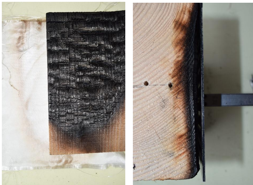
Rysunek 54. Próbką powłoka ECTS 530 - widok od strony ekspozycji i widok od góry
