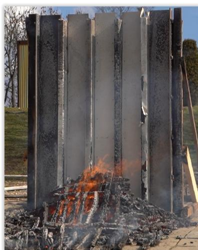
Rysunek 73. Uszkodzenia powłok zabezpieczających przed rozpoczęciem gaszenia czas 29'30''
