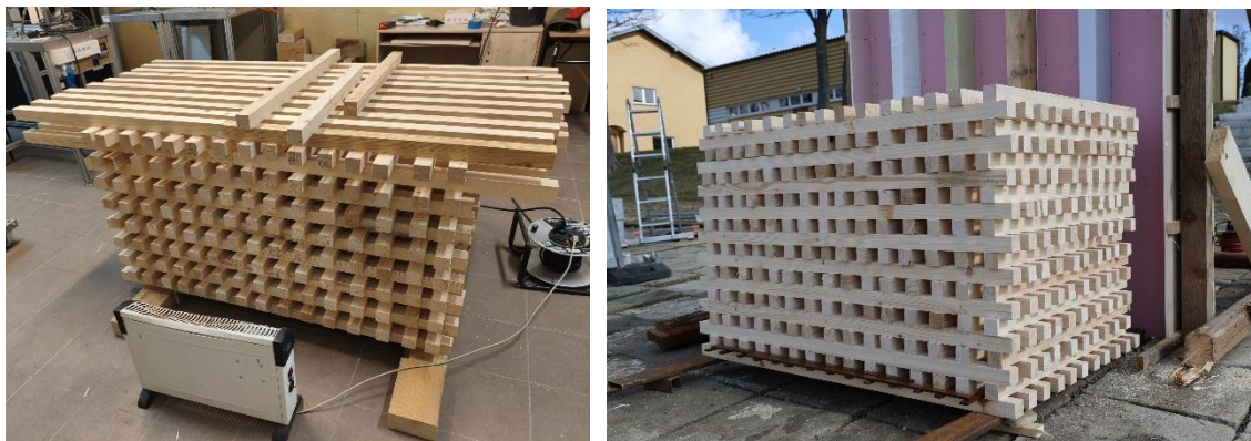
Rysunek 64. Suszenie beleczek w laboratorium oraz gotowy stos na stanowisku
