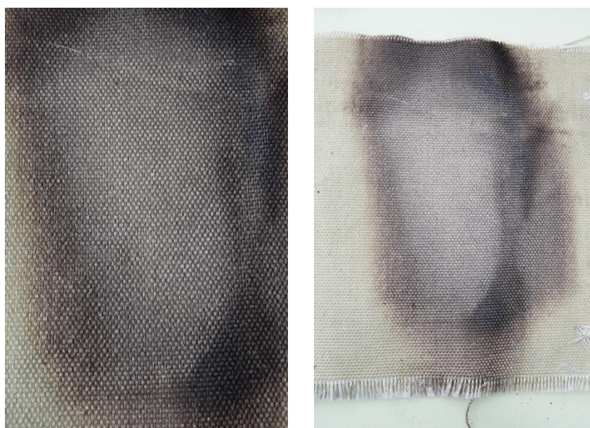
Rysunek 53. Powłoka z włókna szklanego z modyfikacją wermikulitem po próbach na stanowisku z promiennikami
