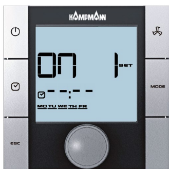
Ekran wprowadzania czasu włączenia
