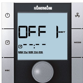
Ekran wprowadzania czasu wyłączenia
