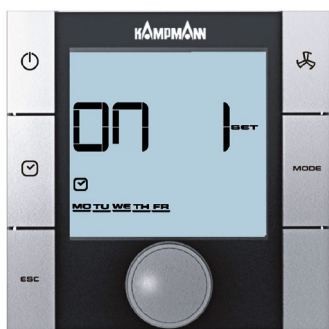
Ekran wprowadzania numeru programu czasowego
