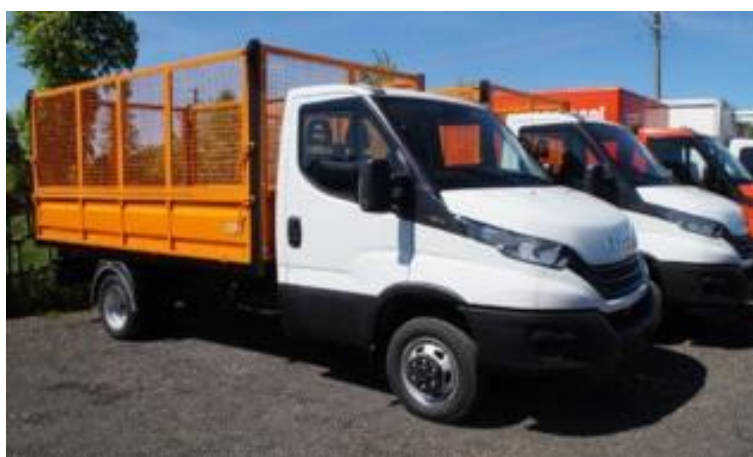
Samochód wyposażony w burty częściowo pełne oraz częściowo przeierne
