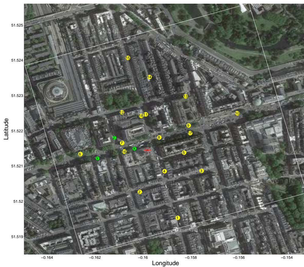
Rysunek 3.7. Mapa prezentująca obszar eksperymentu DAPPLE. Zielony punkt X – lokalizacja źródła; żółte punkty – lokalizacja 18 sensorów; czerwona gwiazdka – stacja meteorologiczna na dachu budynku rady miejskiej.
