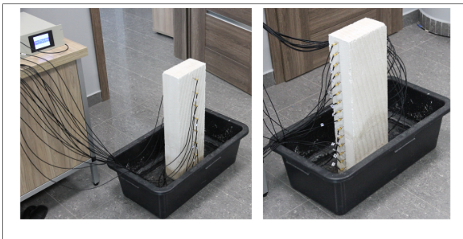
Rysunek 5: Badanie zawilgoce- nia betonu komórkowego.
